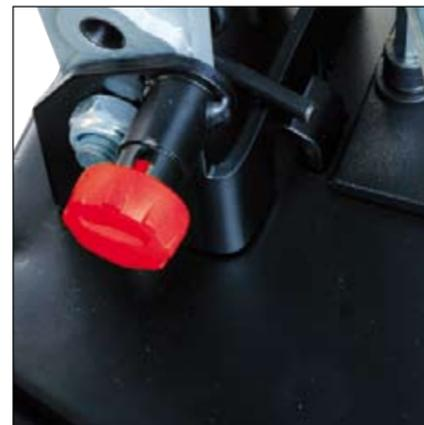
Transportsicherung im eingeklappten Zustand
