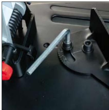
Winkelanschlag stufenlos verstellbar von 0-45° – einfache und genaue Gehrungsschitte
